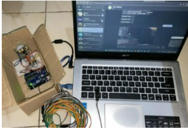
Gambar 2. 22 Alat Keamanan Dengan Notifikasi Telegram
