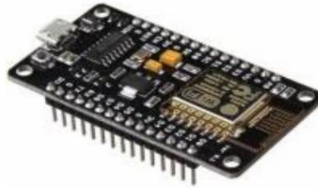
Gambar 2.4 NodeMCU 1.0 unofficial atau V3 (Sumber gambar https://elektrologi.ipitek.web.id/ )
